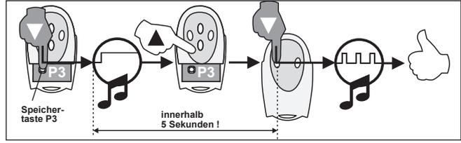
3. Durch Drücken der weißen Speichertaste P3 wird der Empfänger in den Speichermodus versetzt, was durch einen, vom Empfänger ausgehenden, 5sek. langen Dauerton angezeigt wird. Sobald Sie diesen Dauerton hören, lassen Sie die Taste P3 los.
