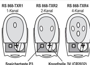
Der Empfänger prüft das ankommende Sendersignal auf richtige Codierung, bevor der Befehl weitergeleitet wird. Hierzu muss die Sendertaste ca. 1-2 Sekunden betätigt werden.
